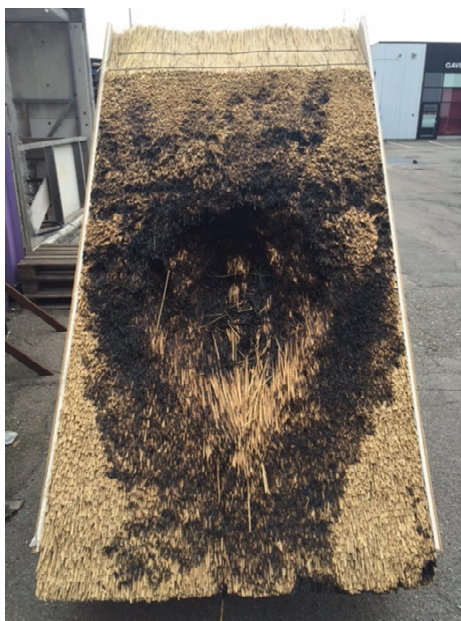
Foto 11: Tagmodel 2 (30 mm hulrum og Sepatec).
