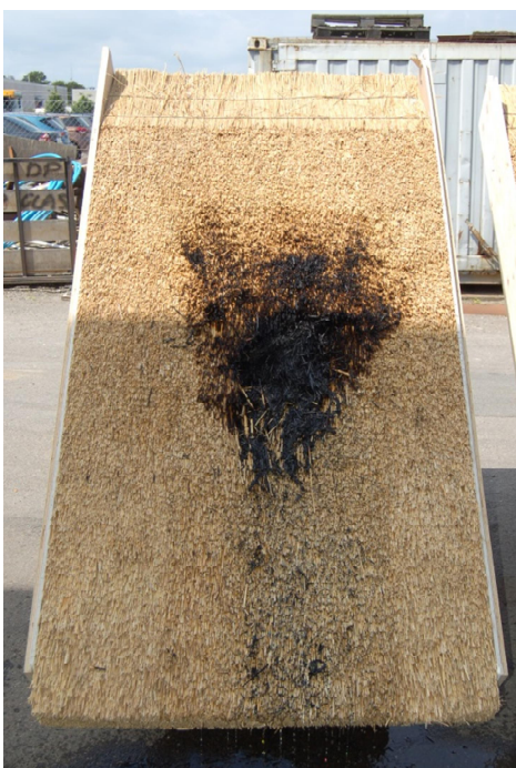
Foto 12: Tagmodel 3 (60 mm hulrum og Sepatec).
