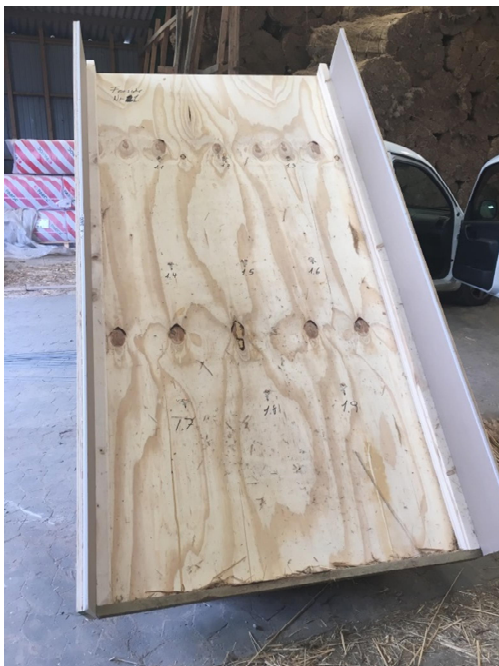
Foto 1: Underliggende EI 30 bygningsdel af materiale mindst D-s2,d2 (to lag 18 mm krydsfiner).
