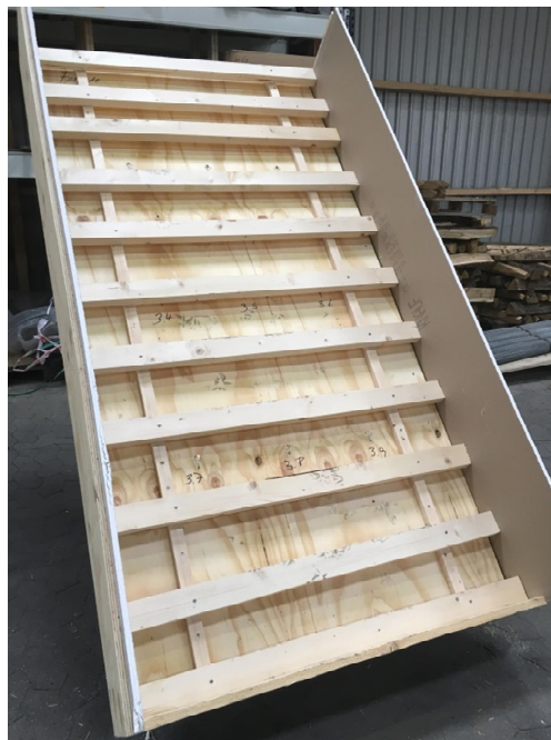
Foto 2: Opbygning af lægtelag (tagmodel 2 og 3) med hulrum mod underliggende EI 30 bygningsdel.
