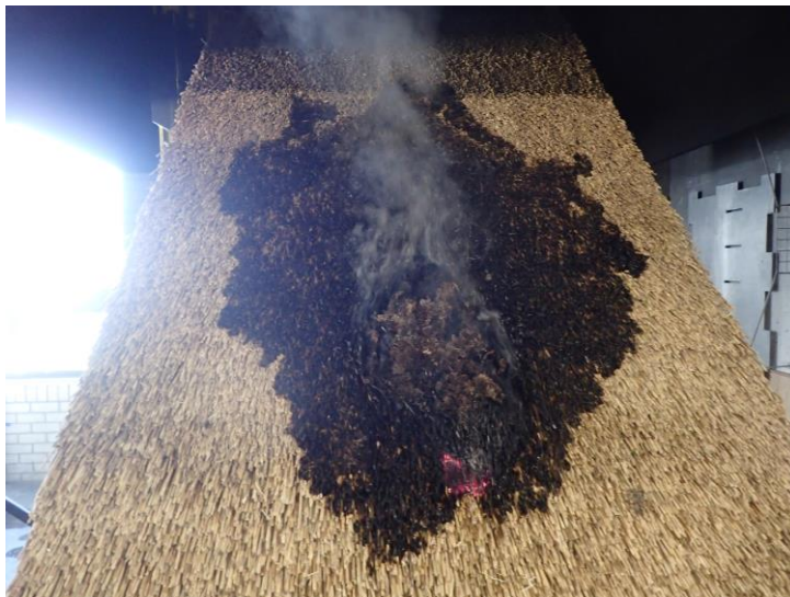
Foto 10 Het verbrande oppervlak van de dakbedekking van proefstuk 2.
