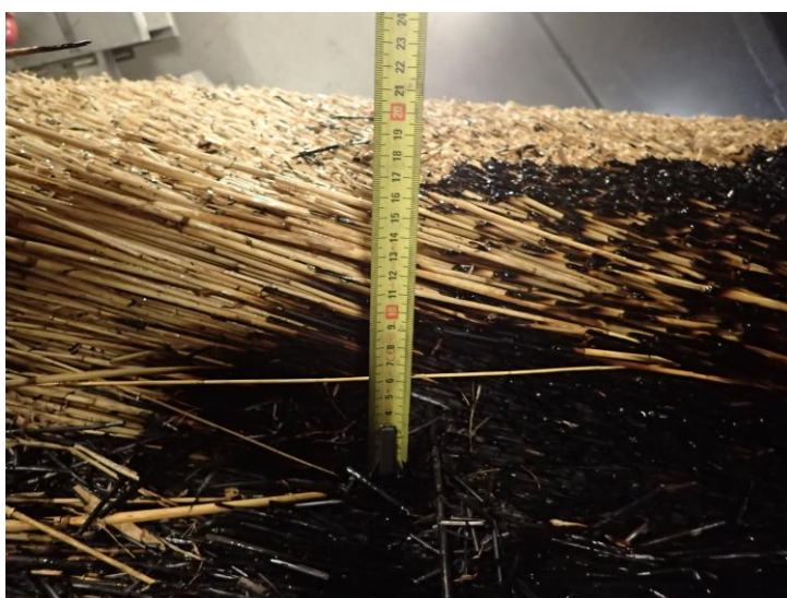
Foto 9 De beschadigde diepte van het riet van proefstuk 1.
