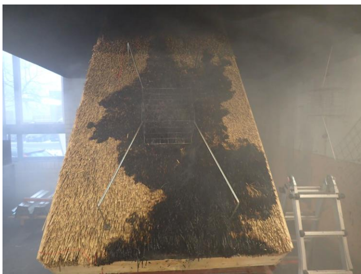
Foto 9 Het verbrande oppervlak van de dakbedekking van proefstuk 1.
