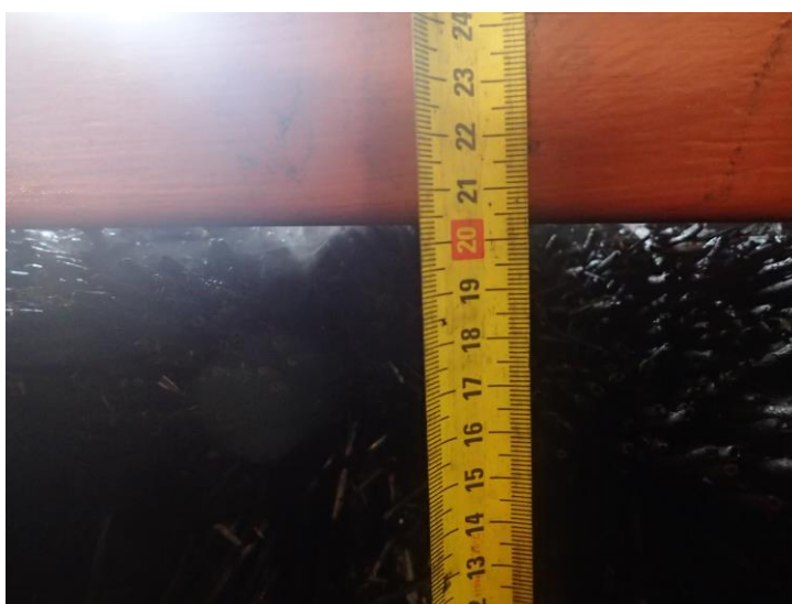
Foto 15 De beschadigde diepte van het riet van proefstuk 4.
