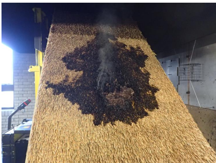
Foto 12 Het verbrande oppervlak van de dakbedekking van proefstuk 3.
