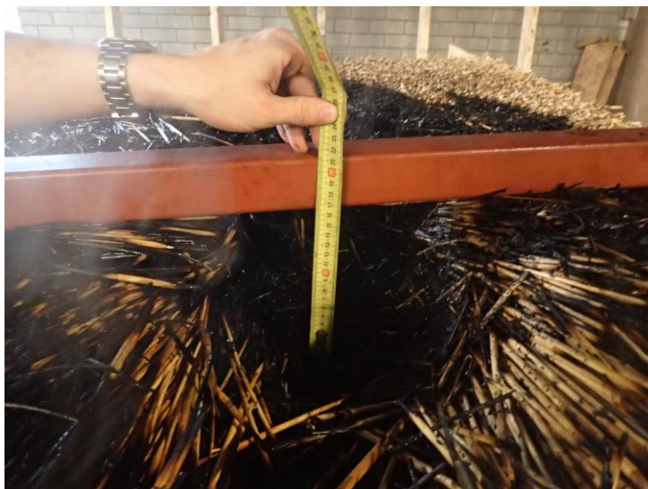
Foto 11 De beschadigde diepte van het riet van proefstuk 2.
