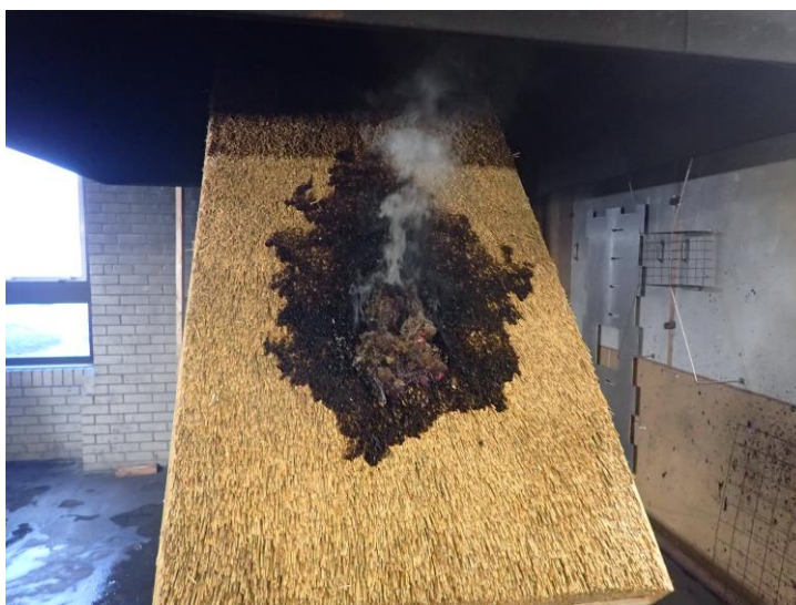
Foto 14 Het verbrande oppervlak van de dakbedekking van proefstuk 4.
