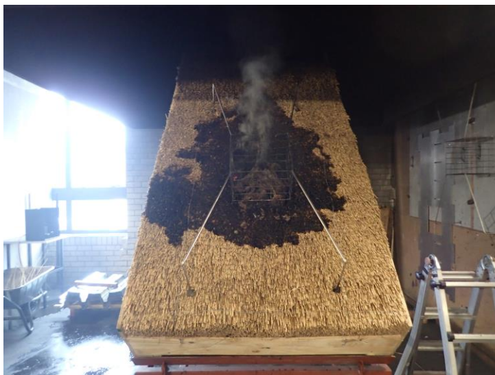
Foto 8 Het verbrande oppervlak van de dakbedekking van proefstuk 1.
