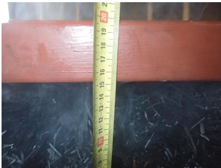
Foto 13 De beschadigde diepte van het riet van proefstuk 3.
