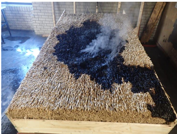
Foto 14 Het verbrande oppervlak van de dakbedekking van proefstuk 4.
