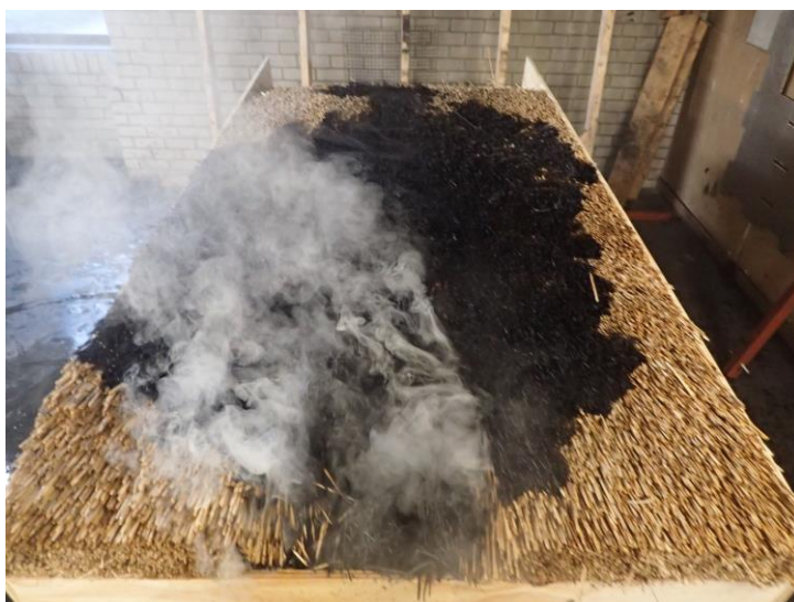
Foto 11 Het verbrande oppervlak van de dakbedekking van proefstuk 2.
