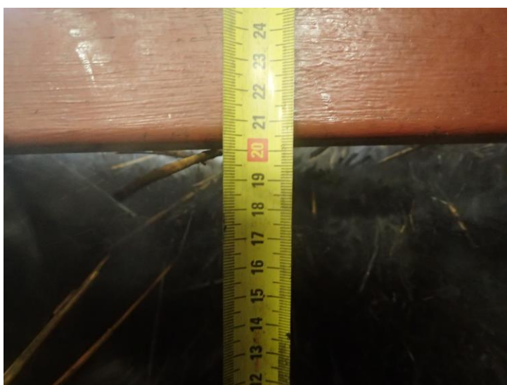
Foto 12 De beschadigde diepte van het riet van proefstuk 2.
