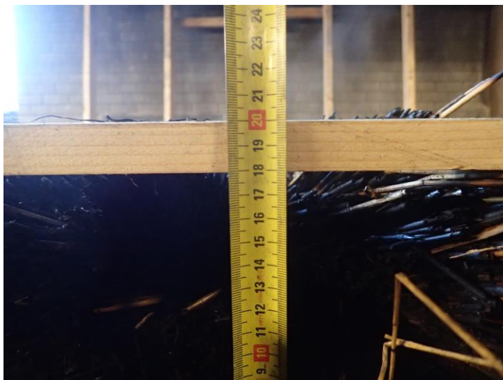
Foto 10 De beschadigde diepte van het riet van proefstuk 1.
