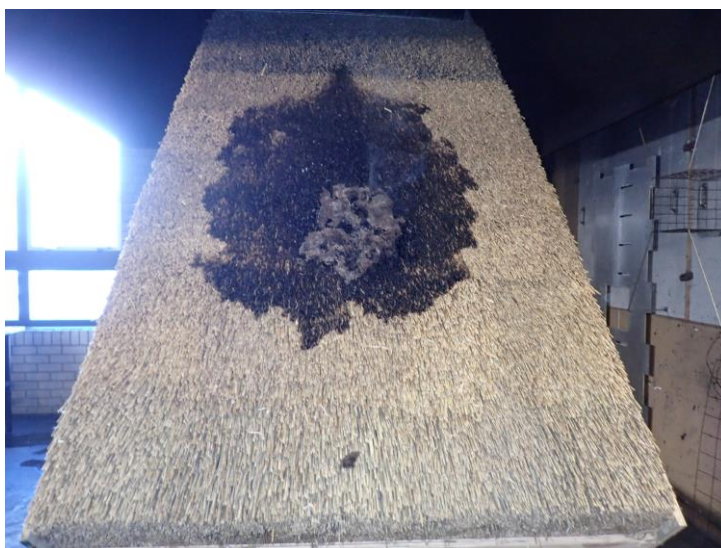
Foto 12 Het verbrande oppervlak van de dakbedekking van proefstuk 3.
