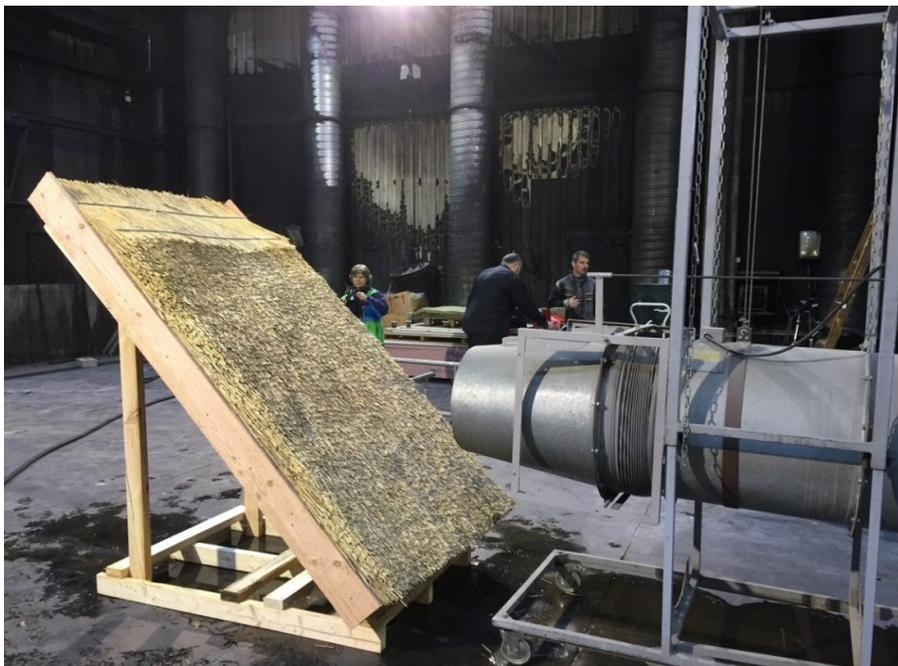
Foto 5: Forsøgsopstilling af tagmodel og vindturbiner.
