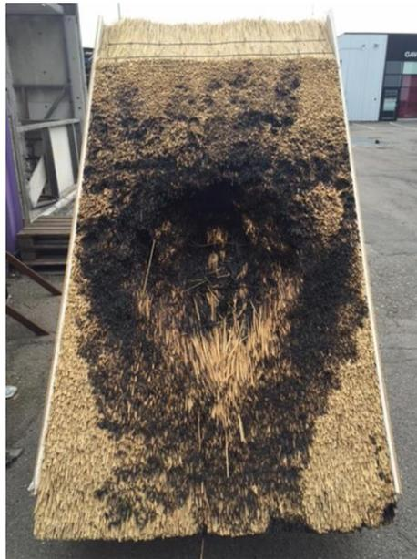
Foto 11: Dachmodell 2 (30 mm Hohlraum und Sepatec).
