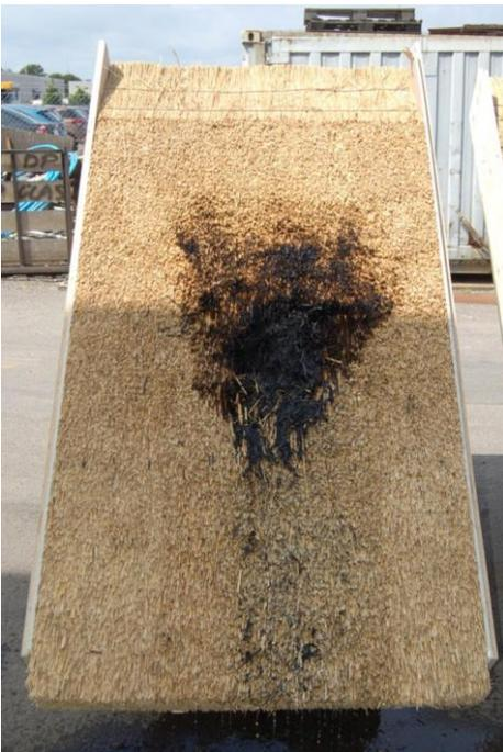
Foto 12: Dachmodell 3 (60 mm Hohlraum und Sepatec).
