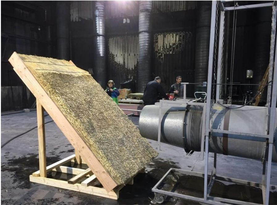
Foto 5: Versuchsanordnung aus Dachmodell und Windturbine.
