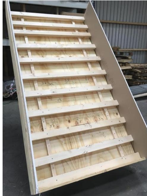
Foto 2: Aufbau einer Lattenkonstruktion (Dachmodell 2 und 3) mit einem Hohlraum zum darunter befindlichen EI 30-Bauteil hin.
